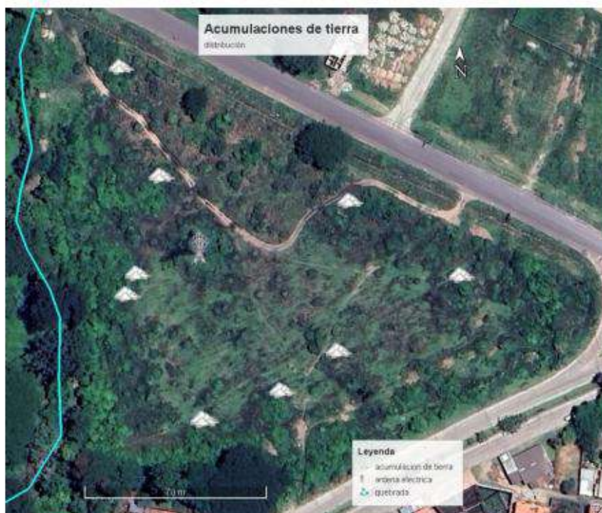
Distribución de las acumulaciones de tierra en el terreno de la inspección.
