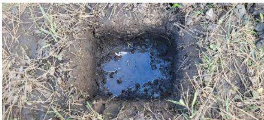
En la tercera capa empieza el fluido de agua del nivel freático
