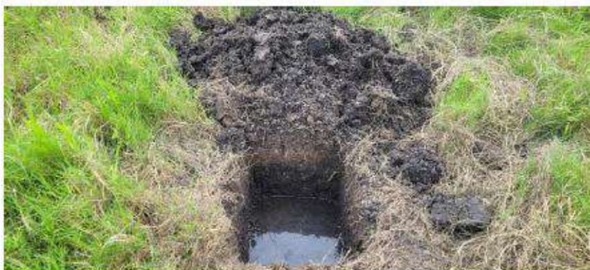
En el centro del terreno se observa el nivel freático ya en la segunda capa estratigráfica
