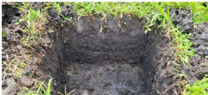
Se observar dos capas estratigráficas esto sucede en la parte sur del terreno.
