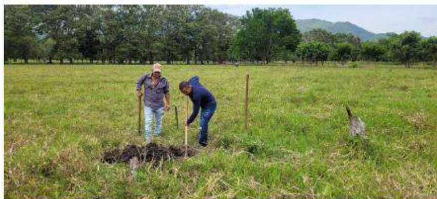
Foto donde se observa la elaboración de los pozos de sondeo
